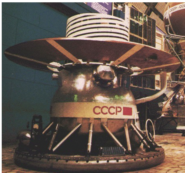
Рис. 4. (В цвете онлайн.) Аппарат "Венера-13" при лабораторных испытаниях. Закрытый крышкой вход ТВ-камеры выступает в верхней части сферического корпуса, над надписью "СССР". Спиральная всенаправленная передающая антенна находится над круглым щитом, который замедлял спуск аппарата в плотной атмосфере планеты. Посадочный буфер внизу поглощал энергию удара при посадке. Кольцо справа над посадочным буфером — антенна прибора "Гроза", с помощью которого были обнаружены электрические разряды в атмосфере Венеры. Высота аппарата до круглого парашютного щита 1 м.
